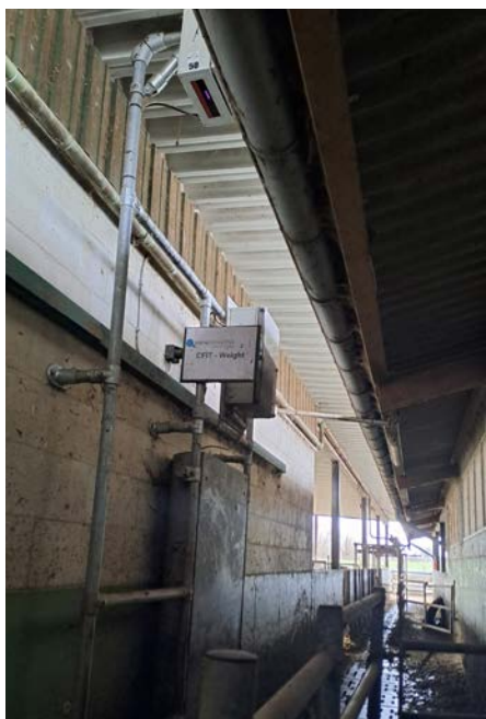
Die angebrachte Kamera erfasst das Körpergewicht der Kühe.
