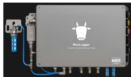
Sniffer ermöglichen die tierindividuelle Messung von Methan- und CO 2 -Emissionen. Die „Nase“ (links dargestellt) saugt die Atemluft der Kühe an und die Messung der Gase findet im eigentlichen Gerät statt.
